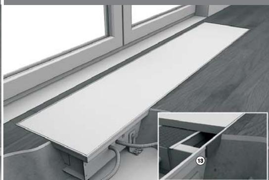
Не допускайте, чтобы корпус канала испытывал нагрузки со стороны пола. Может произойти деформация установочного уголка решетки и повреждения решетки. При использовании расширяющихся половых покрытий, например паркета, а также системы "теплый пол", необходимо устанавливать в месте стыка рамки отопительного канала с покрытием компенсационные швы, например пробковую, либо резиновую полосу (18).
