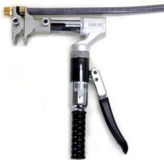
Используя рукоятку, подать давление на фитинг. Соединение завершено после того, как монтажная гильза защелкнется на замке фитинга. Нажмите рычаг стравливающий давление, удалите готовое соединение.
