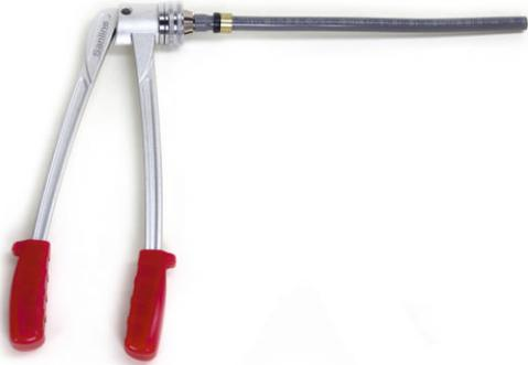
Постепенно расширить трубу 2-3 раза, каждый раз поворачивая расширитель вокруг своей оси на 30°.
