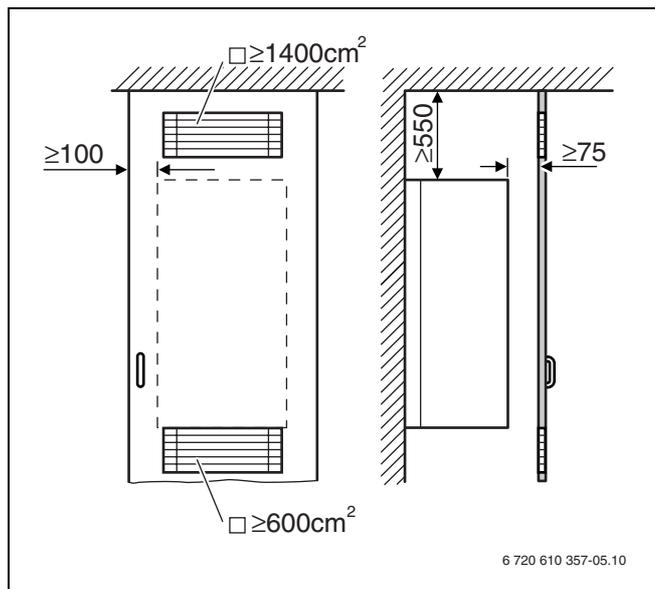
Рис 6 Вентиляционные отверстия при установке в шкафу
