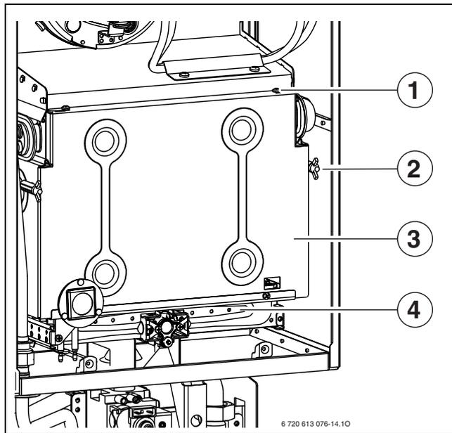
Рис 34 Открывание горелки
