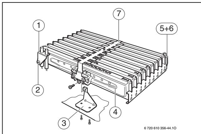
Рис 31 Узел горелки
