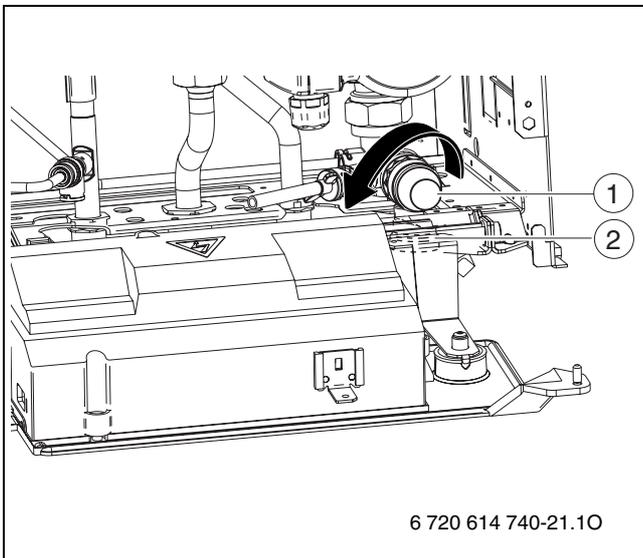
Рис 37 Предохранительный клапан
