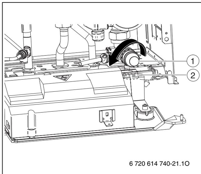
Рис 39 Предохранительный клапан
