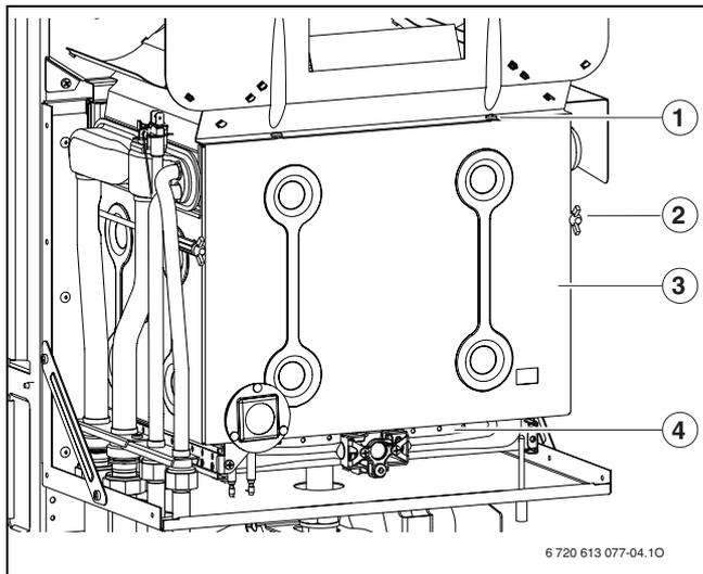
Рис 30 Открывание горелки
