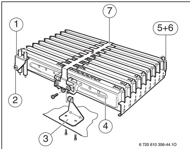
Рис 35 Узел горелки
