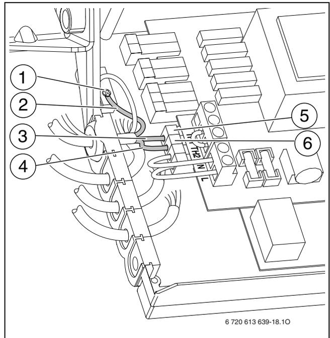
Рис 16 Подключение сетевого кабеля 230 В перем. тока
