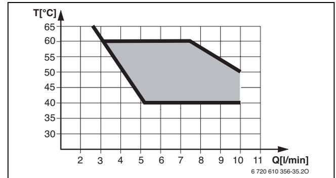
Рис 21 Диаграмма при температуре холодной воды на входе +15 °C
