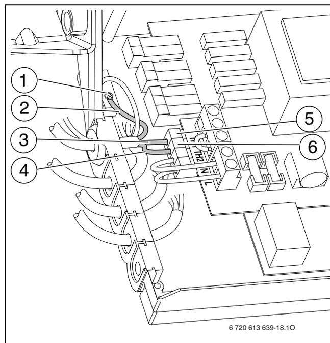
Рис 15 Подключение сетевого кабеля 230 В перем. тока
